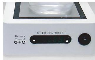
攪拌ON/OFF部・速度調節ボタン部・
