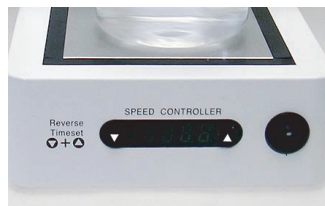
攪拌ON/OFF部・速度調節ボタン部・ 正転-反転切替えボタン部
