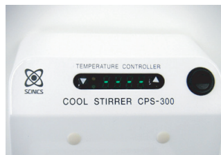
冷却・加熱ON/OFF部・温度調節ボタン部
